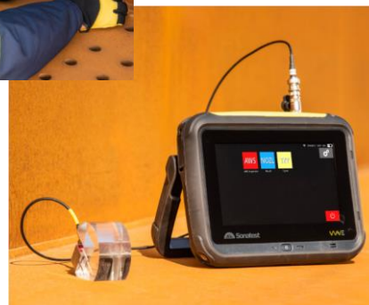
WAVE interaktív letapogatási terv T-csatlakozás ellenőrzéshez
