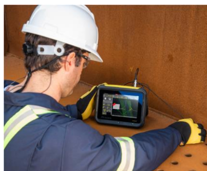
WAVE interaktív letapogatási terv T-csatlakozás ellenőrzéshez
