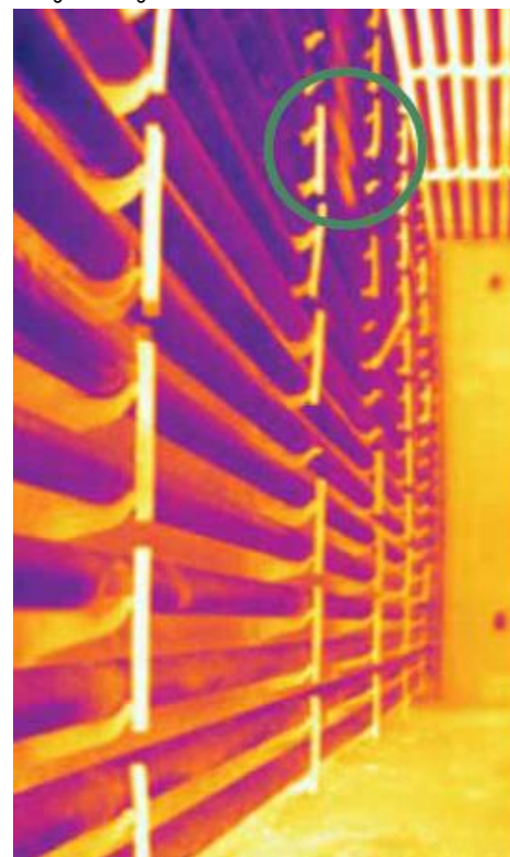
A FLIR hőkamerájával végzett vizsgálat közben felfedezték ezt a forró pontot a csöveken, amely lángvisszaverődés következménye.
