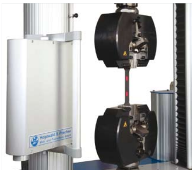
A lézer-extenzométer érintésmentesen, mikronos pontossággal képes mérni a próbatest nyúlását
