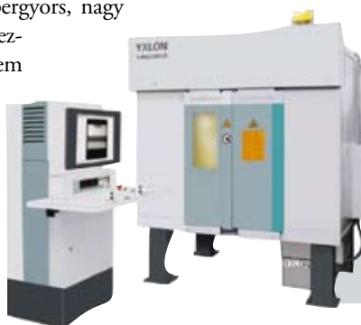
Korszerű röntgenátvilágító kabin digitális vezérlőpulttal
