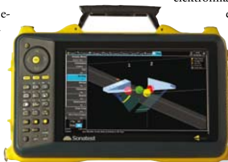
Fázisvezérelt ultrahangos készülék, kétdimenziós metszetkép ábrázolásával
