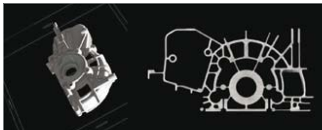
Rekonstruált CT kép és metszet alumínium alkatrészekről
